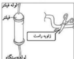
۲. جهت نصب فیلتر ابتدا فاصله مناسبی را بین فیلتر ورودی آب در نظر بگیرید توجه داشته باشید که فیلتر باید بصورت عمودی نصب شود سپس طبق شکل فیلتر را نصب کنید.
