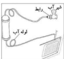
۷. پس از نصب سیستم آب ورودی دستگاه را روشن کنید، دکمه WATER را بعدt ۳-۲ دقیقه فشار دهید تا هوا موجود در لوله ها و مخازن خارج شده و مخازن پر از آب شود. در آخر مجدداً سیستم را بررسی کنید که نشی نداشته باشد. پس از نصب ناید دستگاه را تکان دهید.
