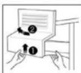
▪ در هنگام تمیز کردن، دکمه قفل یخساز(ICE MAKER LOCK) را فشار دهید.
