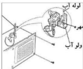
۵. برای اتصال لوله آب به یخچال در پوش پشتی دستگاه را باز کرده و حلقه اتصالی را به لوله آب بیندید سپس لوله آب را به بالای لو آب (WATER VALVE) متصل کرده و مهره آنرا محکم کنید (لو آب در قسمت راست موتور قرار دارد). بررسی کنید که لوله پیچ خوردگی یا نشی نداشته باشد. در آخر در پوش پشتی را مجدداً بیندید. لوله آب باید در شیار روی کاور موتور و بدنه یخچال قرار گیرد در غیر اینصورت به لوله آسیب می‌رسد.
