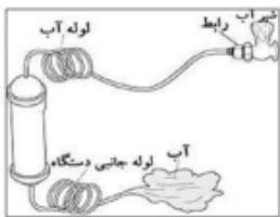
۳. جهت تمیز کردن فیلتر، ابتدا شیر آب را باز کنید و بررسی کنید آیا آب از شیر بیرون می آید سپس شیر را باز بگذارید تا جاییکه آب شفاف و تمیز شود.
