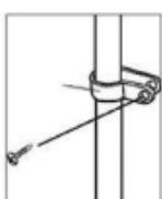
۶. لوله آب را با استفاده از بست لوله به دیوار بیندید و بررسی کنید که لوله گره خورده یا تحت فشار نباشد.
