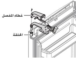
كن حذرًا حتى لا تتسبب في تلف الأسلاك الكهربائية عند إزالة غطاء المفصل.
