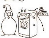
۸- لباسشوئی را نباید در فضای باز یا مکانهای خیلی مرطوب یا نزدیک شیر آب دستشوئی که احتمال نفوذ قطرات آب به قسمتهای الکتریکی دستگاه وجود دارد قرارداد و در صورتیکه قسمتهايی از دستگاه در اثر رطوبت زیاد خیس شده باشد، قبل از استفاده از آن باید کاملاً خشک گردد.
